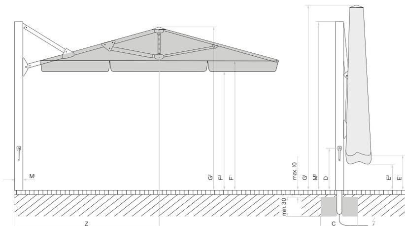
Revêtement de chaussée non fixé max. 10 cm, épaisseur du béton min. 30 cm (tenir compte de la profondeur hors gel), Garantir l'écoulement de l'eau, Ligne d'alimentation électrique.
