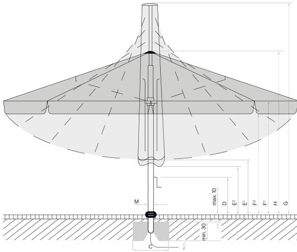
Revêtement de chaussée non fixé max. 10 cm, épaisseur du béton min. 30 cm (tenir compte de la profondeur hors gel), Garantir l'écoulement de l'eau, Ligne d'alimentation électrique.
