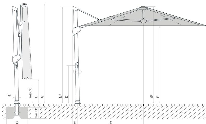
Revêtement de chaussée non fixé max. 10 cm, épaisseur du béton min. 30 cm (tenir compte de la profondeur hors gel),Garantir l'écoulement de l'eau
